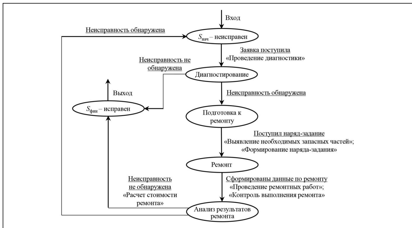
Рис 4. Схема поведения процесса ремонта автомобиля
