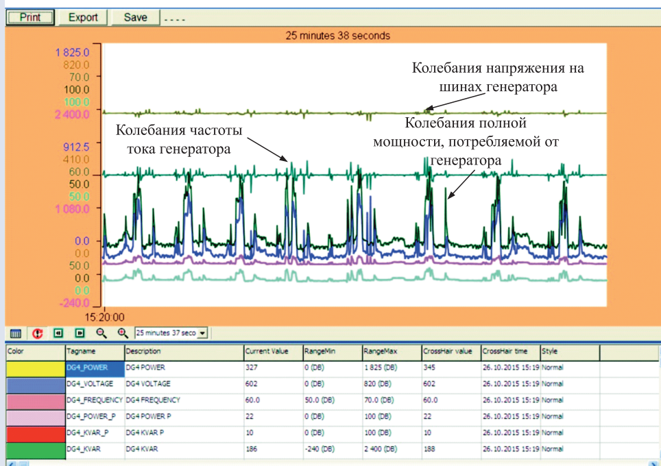
Рис. 1. Основные параметры электроэнергии АЭЭС буровой платформы при спуско-подъемных операциях: а – межкоммутационный интервал 2 мин; б – межкоммутационный интервал 25 мин
