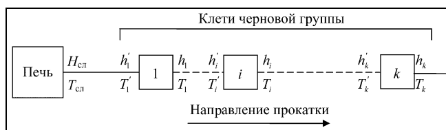
Рис. 1. Схема нагрева и черновой прокатки
