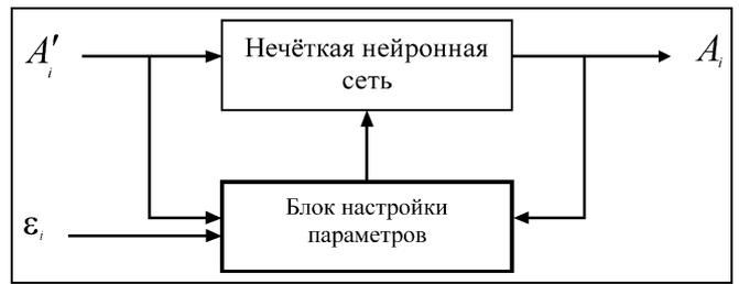
Рис. 2. Структурная схема классификации образов нечеткой нейронной сетью
