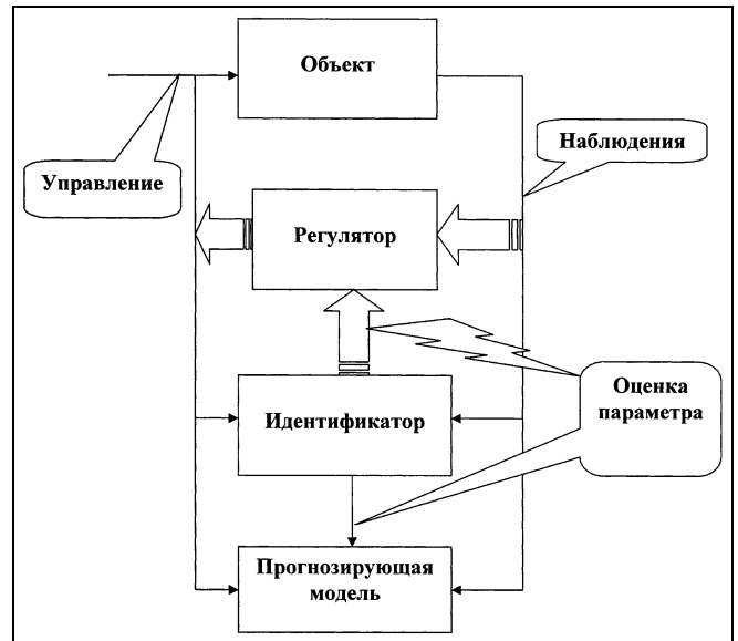
Рис. 1. Прогнозирующая модель объекта в замкнутой системе
