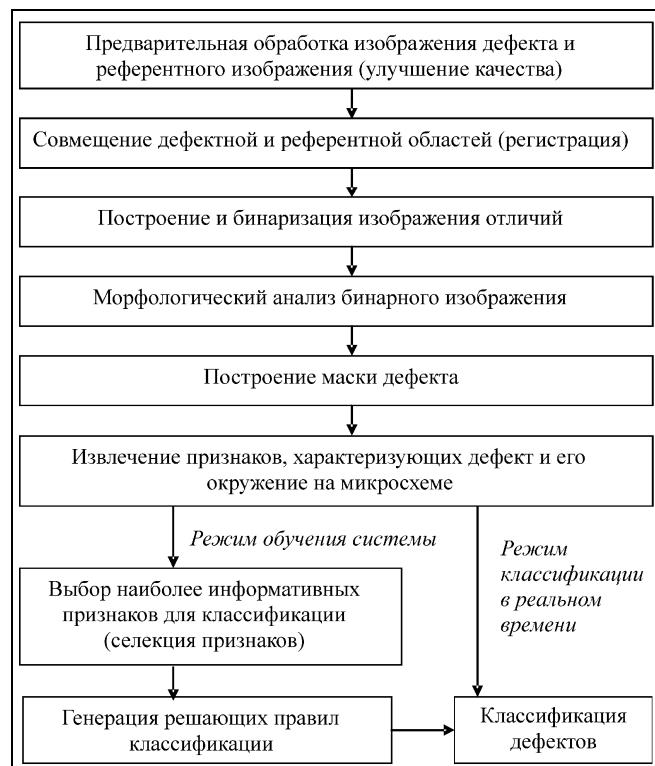
Рис. 2. Последовательность алгоритмических задач, решаемых системой
