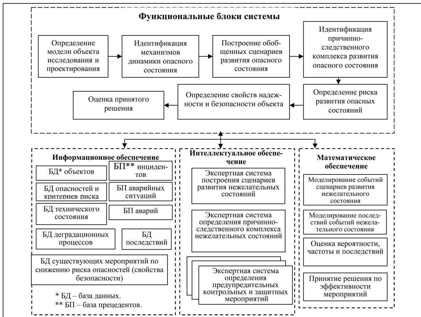
Рис. 4. Архитектура системы исследования и обеспечения надежности и безопасности техногенных объектов
