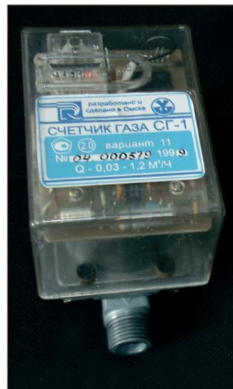
Рис. 4. Бытовой счетчик газа СГ-1
