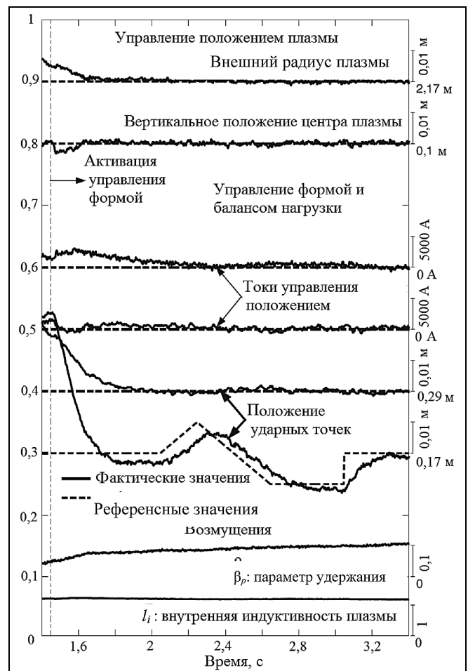
Рис. 11. Управление положением плазмы и координатами ударных диверторных точек на токамаке ASDEX Upgrade [48]
