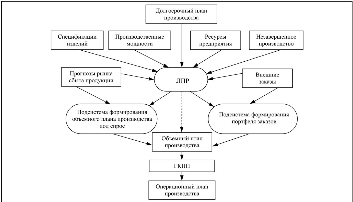
Рис. 2. Схема процесса планирования производства с учетом требований потребителей
