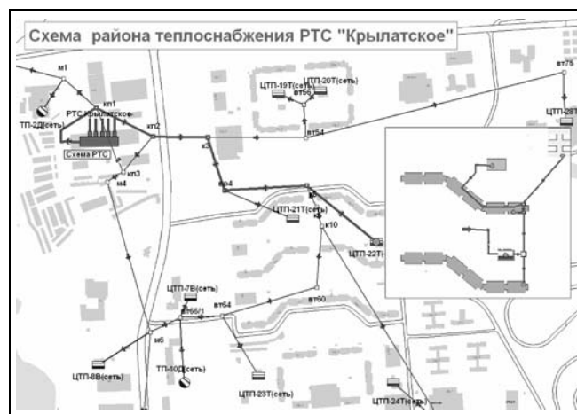
Рис. 7. Отображение карты местности и путей от источника тепла к объекту теплоснабжения одного из районов г. Москвы
