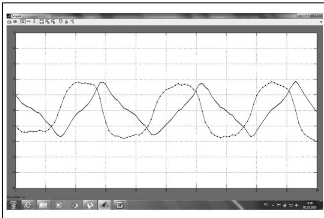
Рис. 2. Переходные процессы в системе на интервале 10 с при отсутствии управлений: процесс  $x_1(t)$  с начальным условием  $x_1(t_0) = 1$  — сплошная линия; процесс  $x_2(t)$  с начальным условием  $x_2(t_0) = -1$  — прерывистая линия
