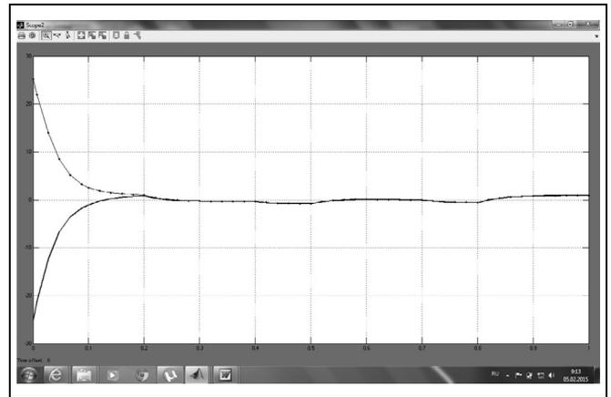
Рис. 4. Графики управляющих воздействий  $u(t)$  и  $w(t)$ : сплошная линия — управление  $u(t)$ ; прерывистая линия — управление  $w(t)$
