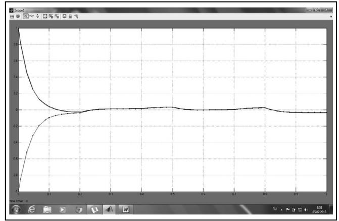
Рис. 3. Графики переходных процессов в системе с управлением на интервале 1 с: процесс  $x_1(t)$  с начальным условием  $x_1(t_0) = 1$  — сплошная линия; процесс  $x_2(t)$  с начальным условием  $x_2(t_0) = -1$  — прерывистая линия
